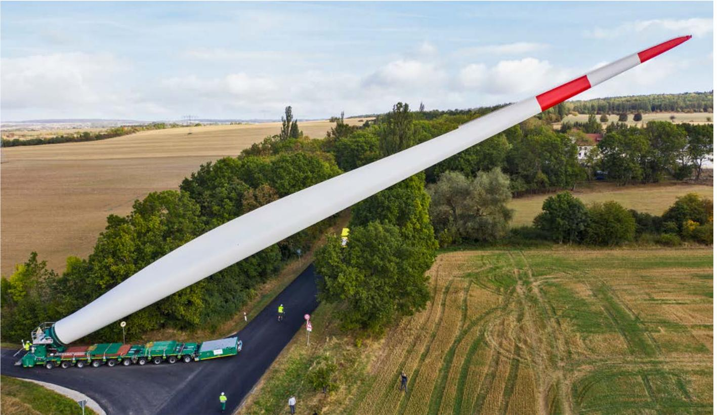
Transport eines 73,7 Meter langen Rotorblattes für eine Vestas V150-4.2 MW zum Windpark Keula in Thüringen Foto: Jan Oelker
