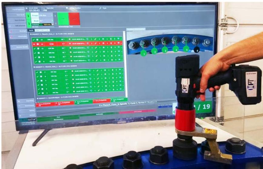
Verschraubung im Werkerleitsystem ProTight™ mit Akkuschauber MAD 20.
