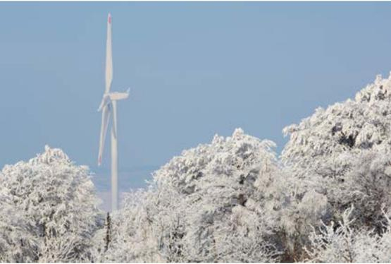
Eisansatz am Rotor einer Enercon E-40 im Windpark Breitenau. Foto: Jan Oelker
