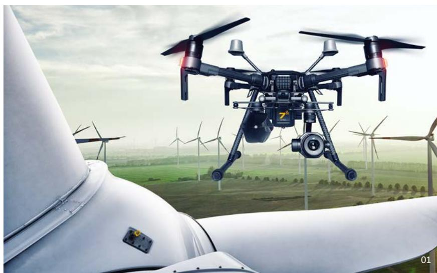
**Einfach und transparent:** Jede Beschädigung wird mit exakten Positionsdaten protokolliert. Spätere Inspektionsflüge liefern an der gleichen Stelle präzise Vergleichsbilder zur Verfolgung einer Schadensentwicklung oder Reparatur.
