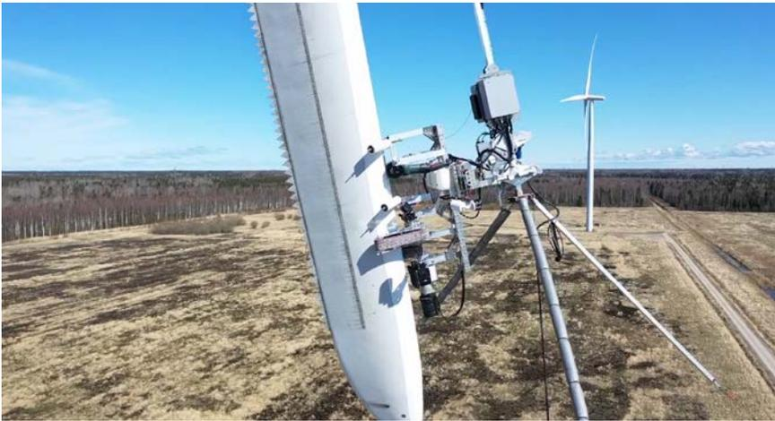
**A**erones hat eine speziell auf Windkraftanlagen ausgerichtete Wartungstechnologie entwickelt, mit der die Wartung der Rotorblätter gegenüber den herkömmlichen Methoden effizienter abläuft und keine Seiltechniker für die Arbeiten an den Rotorblättern mehr erforderlich sind.
